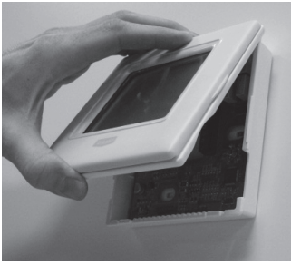
Fig. 16 - Reattach Display Module
